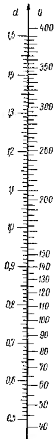
Рис. 11. Номограмма для определения пропускной способности жиклера в зависимости от его сечения:
